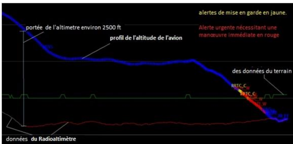
Figure 10a : Profil de l'approche de l'avion ER-AVB sur l'aéroport de Ouagadougou
